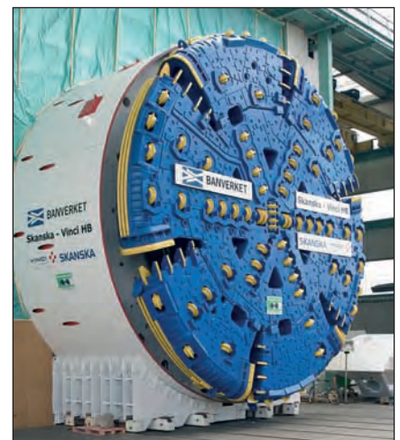
Figure 8 - Tunnelier pré-assemblé dans l'atelier.
