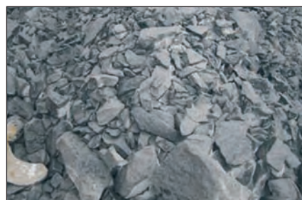
Figure 17 - Marin typique du tunnel présentant des blocs écrasés provenant du creusement en mode ouvert.
