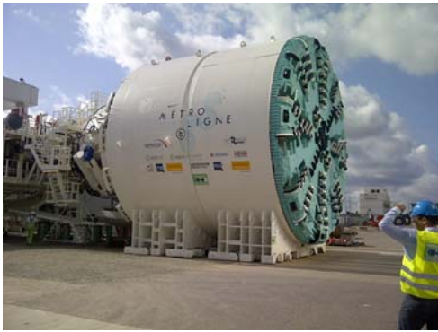
Le tunnelier assemblé chez son fabricant © SEMTCAR
